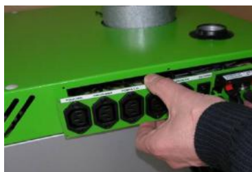
Fot.1. Odkręcić przyłącze zasilająco-czujnikowe
