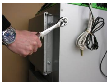
Fot.6. Zdemontować drzwiczki z włazu.
