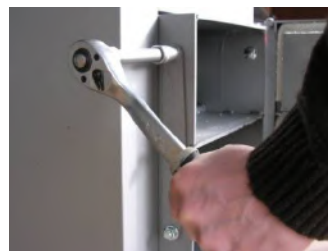
Fot.3. Odkręcić rygiel zamka
