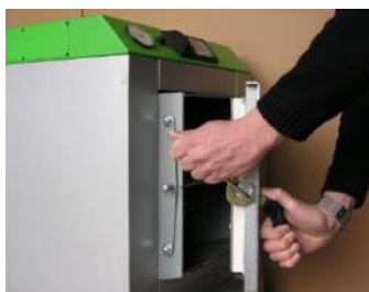
Fot.4. Odkręcić śrubę uchwyty zaciskowego.
