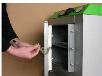
Fot.10. Po odwróceniu zamontować uchwyt zaciskowy.
