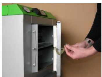
Fot.5. Wyjąć podzespoły mocowania uchwyty.
