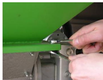
Fot.3. Dokręcić śruby mocujące zbiornik.
