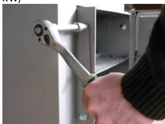
Fot.10. Regulacja rygla zamka (poluzować śruby, ustawić rygiel, dokręcić śruby).
