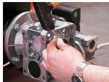
Fot.3. Po ustawieniu współosiowości można wyjąć lub wybić zerwaną zawleczkę.
