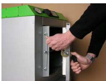
Fot.5. Odkręcić śrubę uchwytu zaciskowego.
