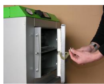
Fot.6. Wyjąć podzespoły mocowania uchwytu.
