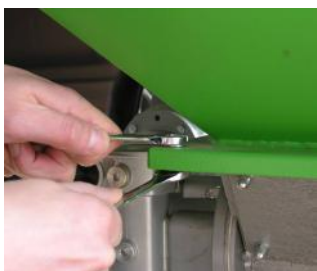
Fot.1. Odkręcić 4 śruby mocujące zbiornik paliwa.
