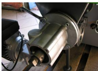
Fot.2. Odkręcić cztery nakrętki mocujące motoreduktor.
