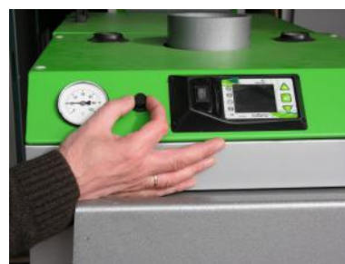
Fot.3. Zakręcić nakrętkę zaślepiającą ogranicznika STB.
