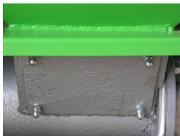
Fot.1. Odkręcić pokrywę otworu rewizyjnego i opróżnić zbiornik z paliwa.
