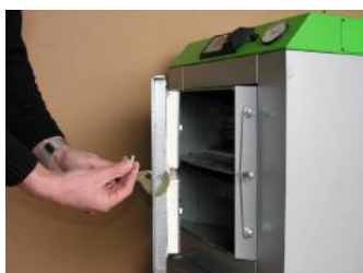
Fot.11. Po odwróceniu zamontować uchwyt zaciskowy.
