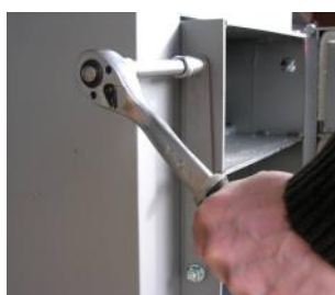
Fot.4. Odkręcić rygiel zamka
